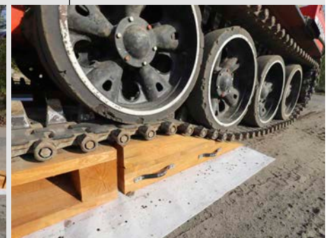
Részlet: Egy láncalpas jármű felhajtása a fa rámpára
