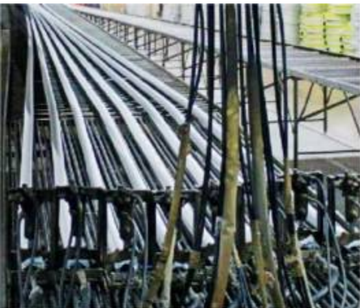
Vulkanizálás folyamata a 60 m hosszú fűtött asztalon
