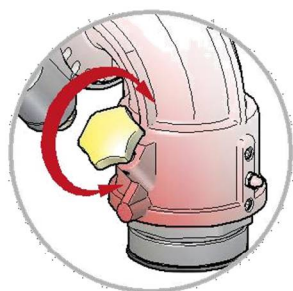
Vízszintes mozgást biztosító retesz és zsírzógomb
